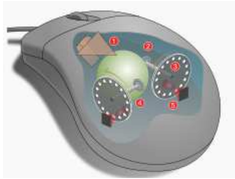
Εικόνα 31 : Λειτουργία ενός μηχανικού ποντικιού
