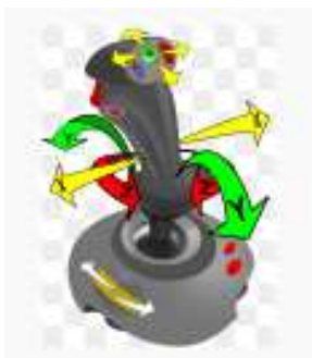
Εικόνα 36 : Πιθανές κινήσεις της ράβδου ενός joystick (στις τρεις διαστάσεις)
