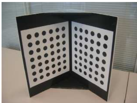
Εικόνα 41 : Ένα τρισδιάστατο πλέγμα που χρησιμοποιείται για την εκτίμηση του πίνακα διαρρύθμισης κάμερας. Σε αυτό, οι τρεις διαστάσεων συντεταγμένες των γωνιών των άσπρων τετραγώνων ως προς την πάνω αριστερή γωνία του πλέγματος είναι γνωστές. Είναι σχετικά εύκολο να βρει κανείς αυτές τις γωνίες της εικόνας και από την αντιστοιχία μεταξύ των τρισδιάστατων σημείων και των δισδιάστατων σημείων εικόνας να υπολογιστούν οι παράμετροι του πίνακα προβολής.
