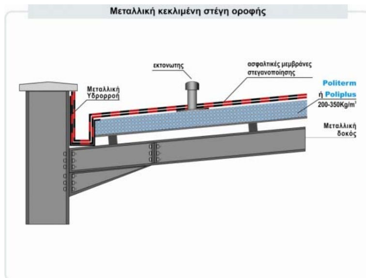
Εικόνα 102. Θερμομονωμένη μεταλλική στέγη με Politerm Blu [45]
