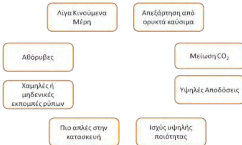
Σχήμα 2.4: Πλεονεκτήματα κυψελίδων καυσίμου
