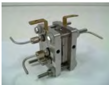
Σχήμα A.8: Συσκευή κυψελίδας καυσίμου πολυμερικής μεμβράνης
