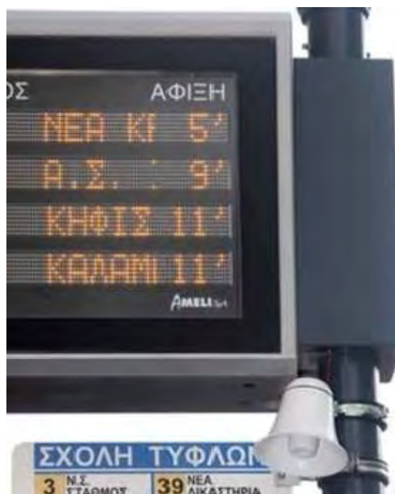
Εικόνα 4.3: Πιλοτικό Σύστημα Φωνητικής Αναγγελίας Διερχόμενων Λεωφορείων
