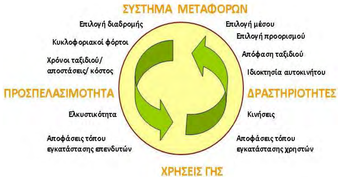
Σχήμα 1.6: Ο κύκλος αλληλεπίδρασης μεταξύ των χρήσεων γης και του συστήματος μεταφορών
