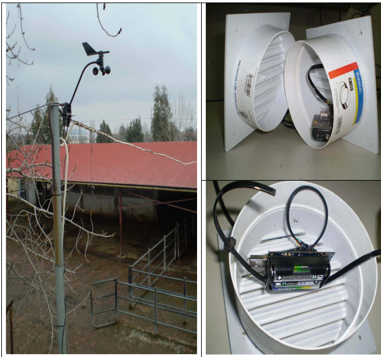
Αριστερά το ανεμόμετρο και δεξιά πιο κοντινό ο Node 2 που συνδεόταν το όργανο της μέτρησης του αέρα.
