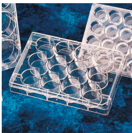
ΕΙΚΟΝΑ 3.2 Ένα δωδεκάτρυπο κυτταρικό δοχείο. Αριστερά του ένα εξάτρυπο, ενώ δεξιά του ένα εισοσιτεράτρυπο κυτταρικό δοχείο.
