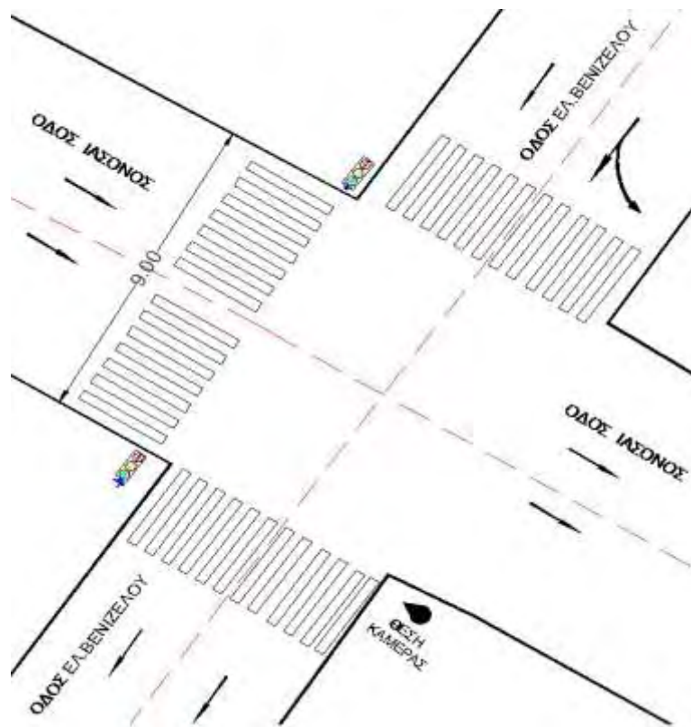
Εικόνα 4.8: Σχεδιάγραμμα κινήσεων στον κόμβο Βενιζέλου και Ιάσονος (μελετούμενη διάβαση επί της οδού Ιάσονος).
