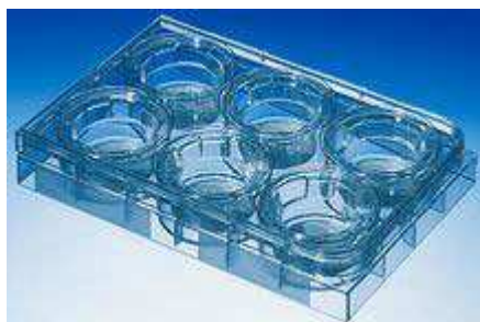
Εικόνα 18α: 6-well πιάτα πολυεστέρα (Transwell™, Permeable Supports, Corning) με υποδοχές συγκαλλιέργειας.
