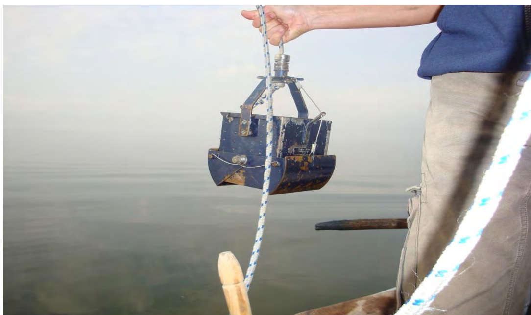
Εικόνα 2.6: Ανοιχτές σαγόνες δειγματολήπτη ECKMAN.
