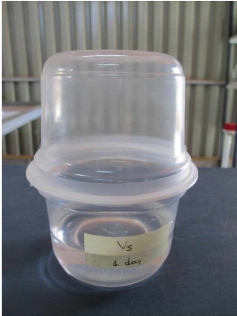
ΕΙΚΟΝΑ 46: Τα δοχεία σκεπάζονταν με αντίστοιχα που στερεώνονταν στο σημείο επαφής τους με μεμβράνη Parafilm® (USA, Chicago, Illinois).
