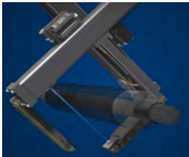
Σχήμα 3.7.3-1 : Σάρωση καλωδίου μέσω συστήματος X-ray
