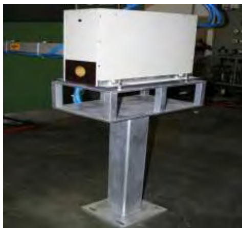
Σχήμα 3.5-1 : Σύστημα επαγωγικής προθέρμανσης αγωγού
