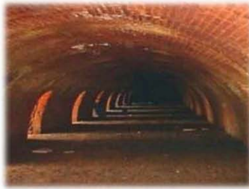
Εικόνα 11: Η κάμινο συνεχούς καύσης τύπου Hoffman.
