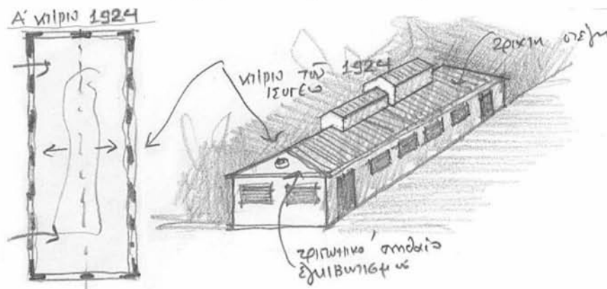
Εικόνα 16: Απλή ορθογωνική κάτοψη χωρίς υποστυλώματα και με μεγάλα ανοίγματα εν σειρά.
