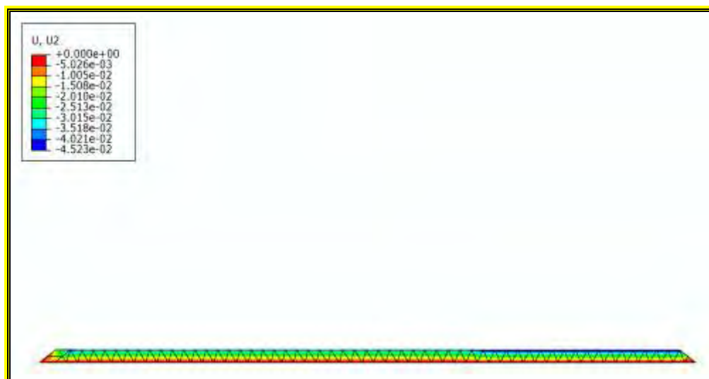
Σχ. 24: 1 η στρώση στην κατασκευή του επιχώματος (βήμα 1)
