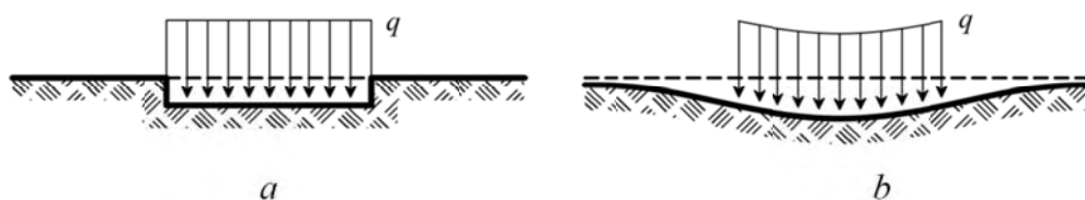
Σχήμα 2.2. Παραμορφώσεις ελαστικής θεμελίωσης υπό ομοιόμορφη πίεση: a – Μοντέλο Winkler, b – πραγματικό εδαφικό στρώμα
