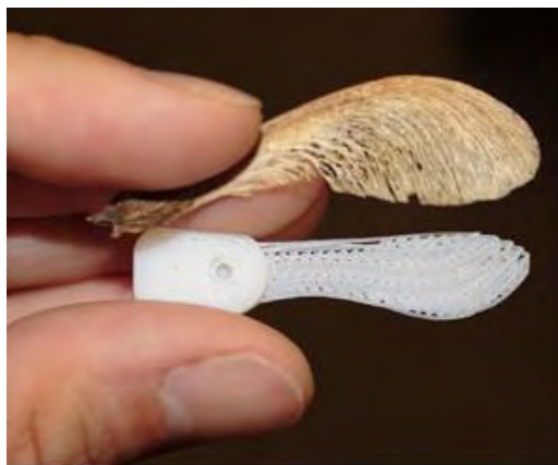
Εικόνα 14 - Nano Air Vehicle (NAV) της Lockheed Martin
