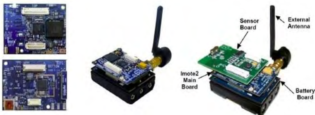
Εικόνα 3-5 : Δομή ασύρματου κόμβου αισθητήρων Imote2 [14]
