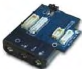
Εικόνα 3-4 : Η πλακέτα τροφοδοσίας IBB2400 και τα χαρακτηριστικά της [12]
