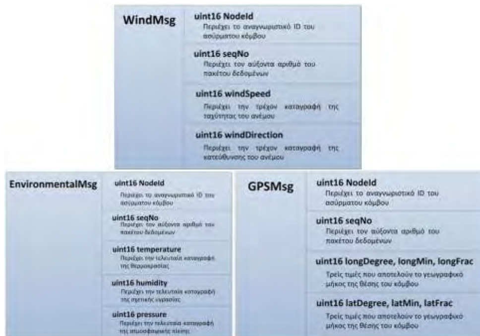
Εικόνα 64: Η μορφή των μηνυμάτων που στέλνονται από το δίκτυο αισθητήρων καταγραφής περιβαλλοντικών δεδομένων προς τον σταθμό βάσης.
