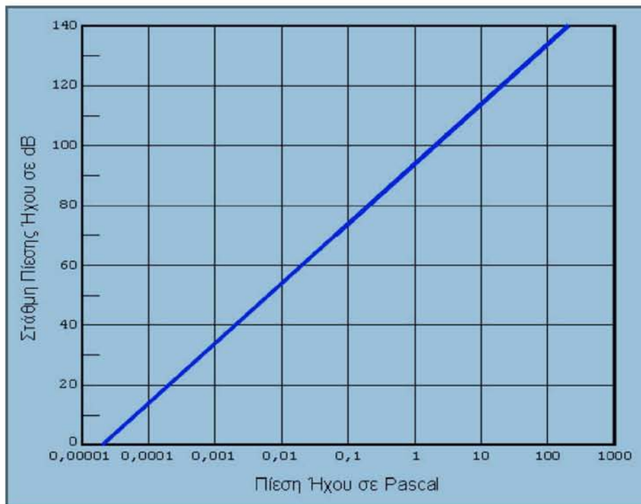
Σχήμα 1.1: Πίεση Ήχου και Στάθμη Πίεσης Ήχου
