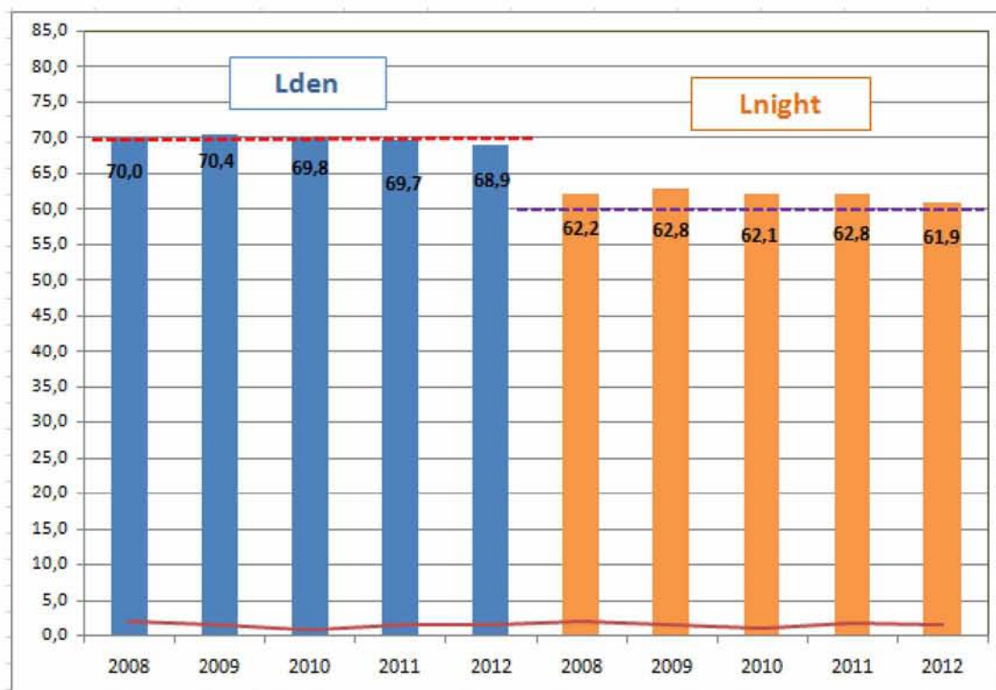
Διάγραμμα 7.8: Μέσος όρος και τυπική απόκλιση των δεικτών Lden & Ln για τα έτη 2008,2009,2010,2011,2012 – Τμήμα: Ελευσίνα – ΑΚ Κηφισίας
