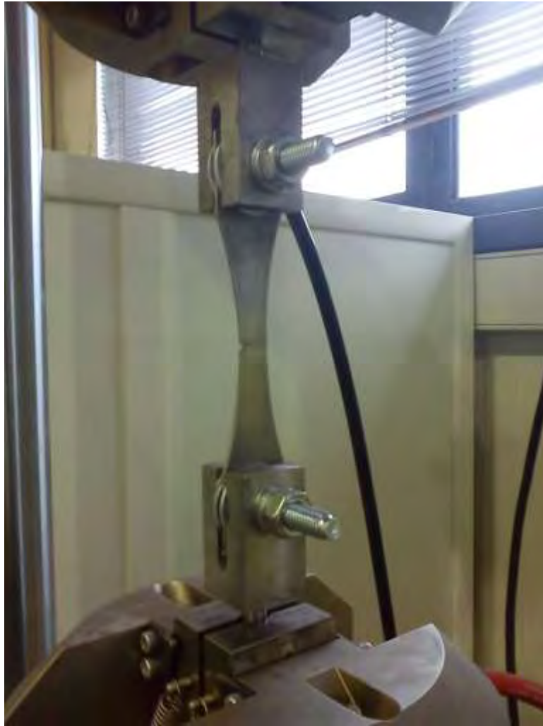
Εικόνα 11. Δοκίμιο κόπωσης με εγκοπή στην μηχανή εφελκυσμού
