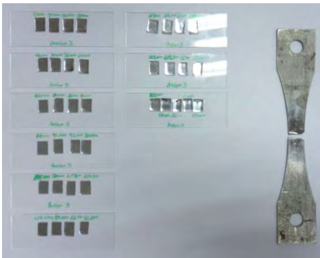
Εικόνα 15. Χαρακτηριστικά αποτυπώματα ρέπλικας για το δοκίμιο 3 του χάλυβα TRIP 700
