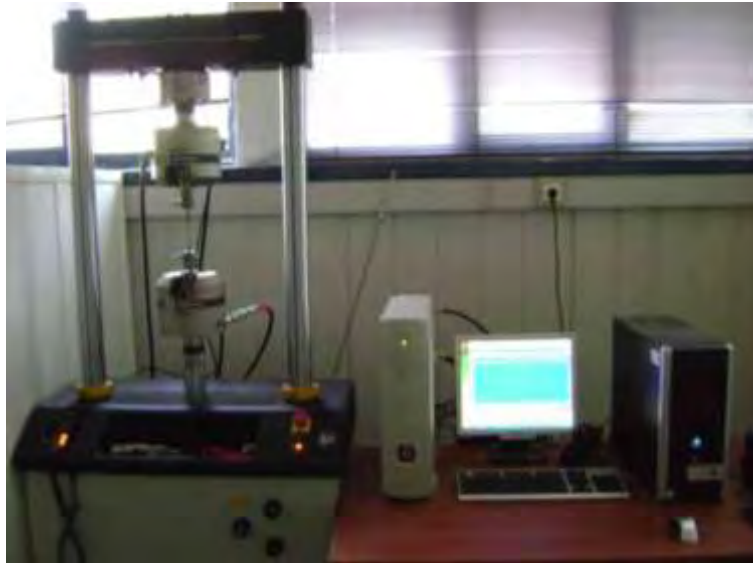
Εικόνα 6. Διάταξη της μηχανής εφελκυσμού Instron του Εργαστηρίου Μηχανικής και Αντοχής των Υλικών
