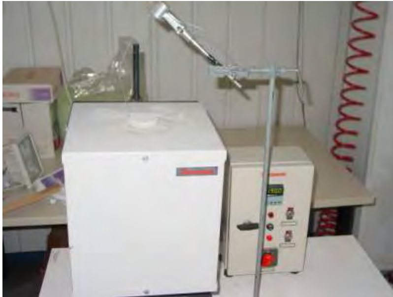
Εικόνα 4.2 Δοκιμή θερμικής κατεργασίας σε κάθετο φούρνο Thermawatt TGT 50
