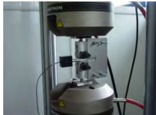
Εικόνα 4.12 Δοκιμή δυσθραυστότητας σε εξέλιξη
