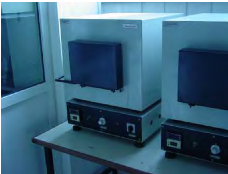
Εικόνα 4.3 Φούρνος όπου έγινε θερμική κατεργασία υπεργήρανσης δοκιμίων C(T)
