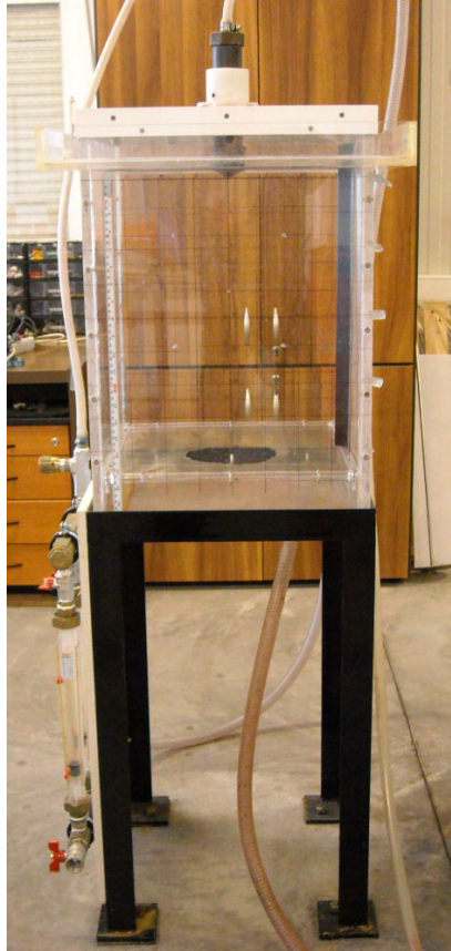
Σχήμα 3.1 Ορθογωνική δεξαμενή διάχυσης
