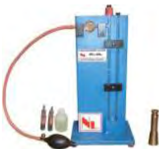
Εικόνα 2.5: Συσκευή Blaine για τον προσδιορισμό της λεπτότητας του τσιμέντου ( http://www.nl-test.com ).
