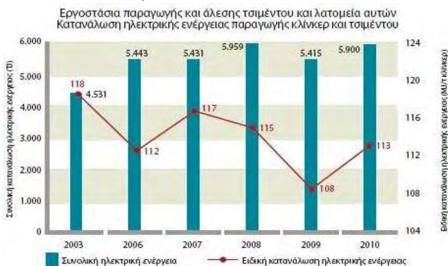
Σχήμα 6.6: Συνολική κατανάλωση ηλεκτρικής ενέργειας (TJ) και ειδική κατανάλωση ηλεκτρικής ενέργειας (MJ/τον κλίνκερ) για την παραγωγή κλίνκερ και τσιμέντου, των εργοστασίων παραγωγής και άλεσης τσιμέντου και των λατομείων, μεγάλης ελληνικής τσιμεντοβιομηχανίας ( www.titan.gr , ίδια επεξεργασία).
