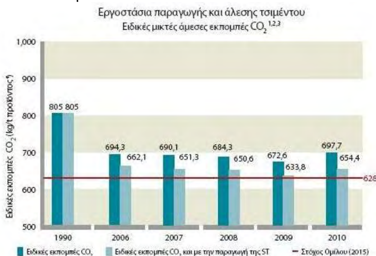
Σχήμα 5.4: Παρουσίαση ειδικών μικτών άμεσων εκπομπών CO 2 (CO 2 kg/τόνο προϊόντος), των εργοστασίων παραγωγής και άλεσης τσιμέντου, μεγάλης ελληνικής τσιμεντοβιομηχανίας ( www.titan.gr/userfiles/File/csr2010/CSR_GR.pdf , ιδία επεξεργασία).
