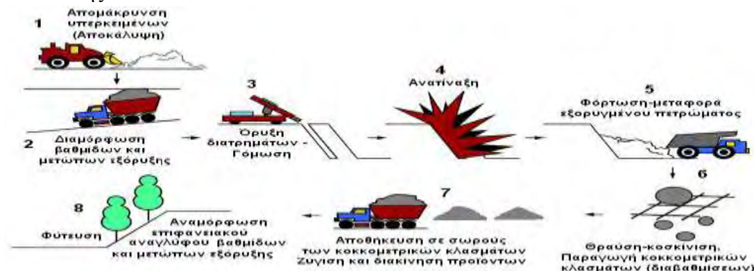
Εικόνα 3.2: Αλληλουχία φάσεων διαδικασίας εξόρυξης και παραγωγής αδρανών υλικών. (Τσακαλάκης, 2010).
