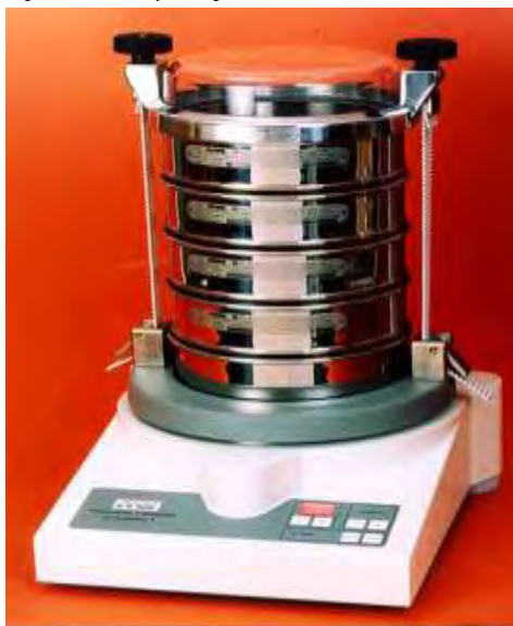
Εικόνα 3.7: Συσκευή κοσκίνισματος αδρανών υλικών ( www.teicrete.gr ).
