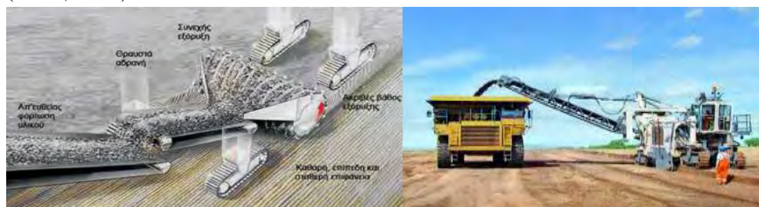
Εικόνα 3.3: Παράδειγμα λειτουργίας μηχανήματος επιφανειακής εξόρυξης για την παραγωγή αδρανών υλικών ( www.helma.gr ).
