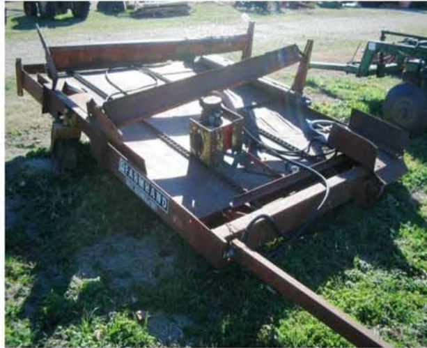
Εικόνα 3.12: Συγκέντρωση δεμάτων σε έλκηθρο πριν την εναπόθεση στον αγρό
