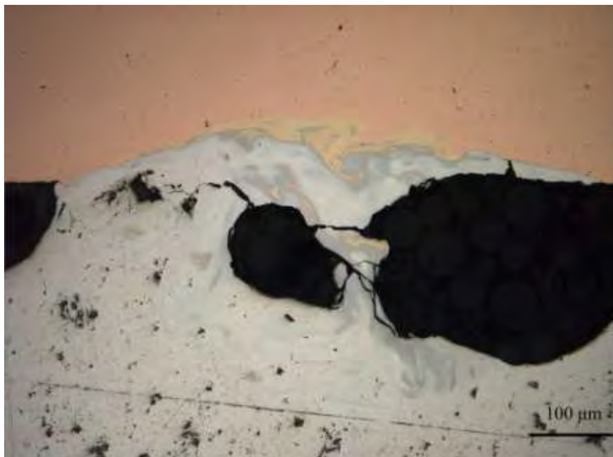
Εικ. 31: Περιοχή συγκόλλησης κατηγορίας Anew (200x)
