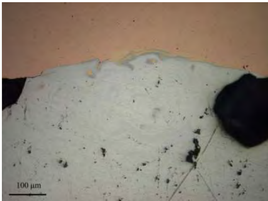
Εικ. 27: Περιοχή συγκόλλησης κατηγορίας A_{new} (200x)
