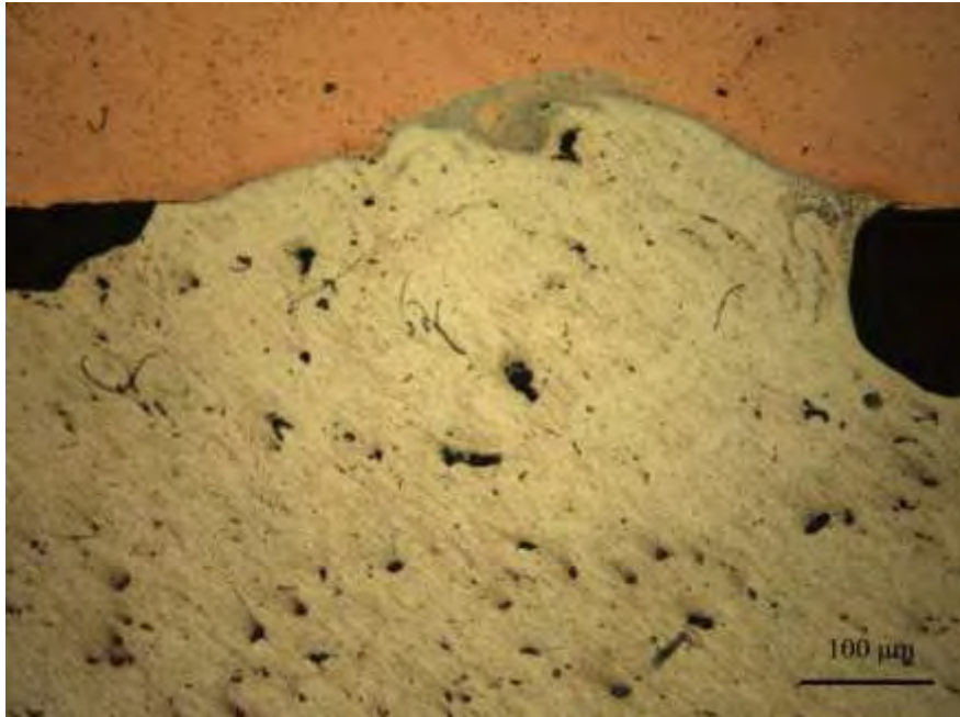
Εικ. 50: Εγκάρσια τομή περιοχής συγκόλλησης κατηγορίας Z (200x)
