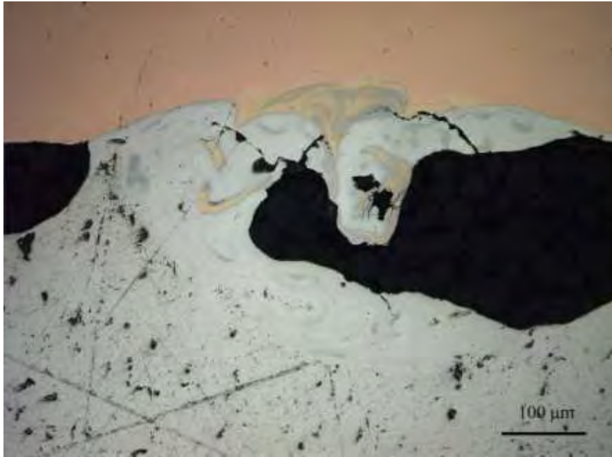
Εικ. 33: Περιοχή συγκόλλησης κατηγορίας Anew (200x)
