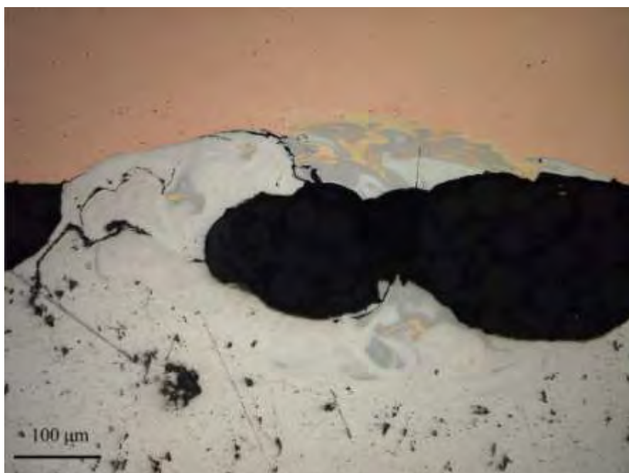
Εικ. 30: Περιοχή συγκόλλησης κατηγορίας Anew (200x)
