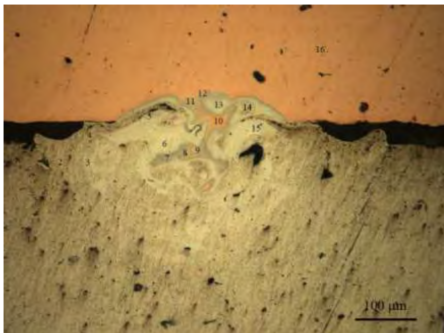
Εικ. 62: Περιοχή συγκόλλησης κατηγορίας ΣΤ, Σημεία μικροσκληρομέτρησης
