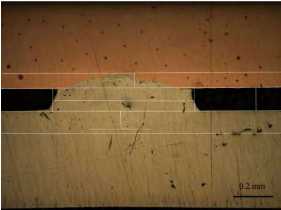
Εικ. 64: Παρουσίαση τρόπου μέτρησης βάθους διείσδυσης και πλάτους συγκόλλησης
