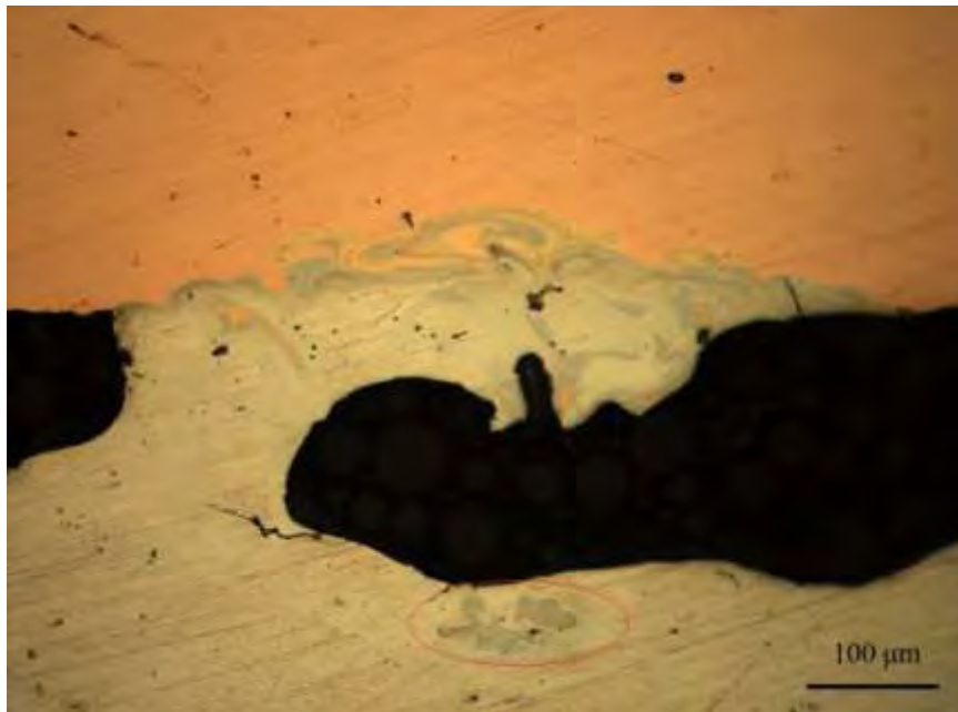
Εικ. 25: Περιοχή συγκόλλησης κατηγορίας B (200x)
