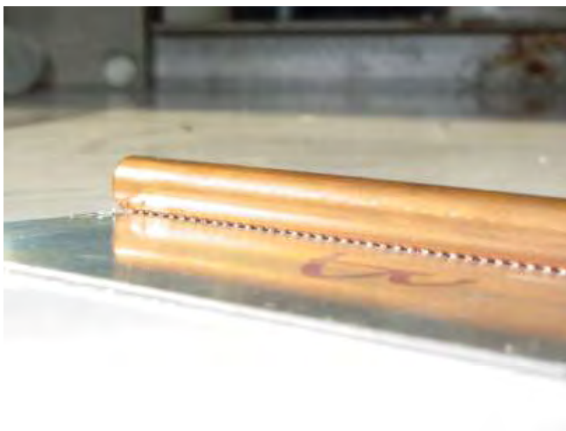
Εικ.8: Σημειακή συγκόλληση με laser ηλιακού συλλέκτη Al-Cu
