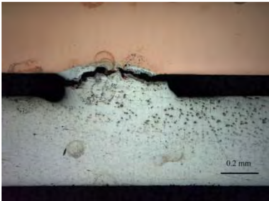
Εικ. 20: Περιοχή συγκόλλησης κατηγορίας B (100x)
