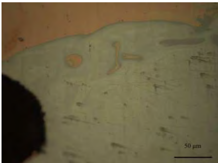
Εικ. 22: Περιοχή συγκόλλησης κατηγορίας B (500x)
