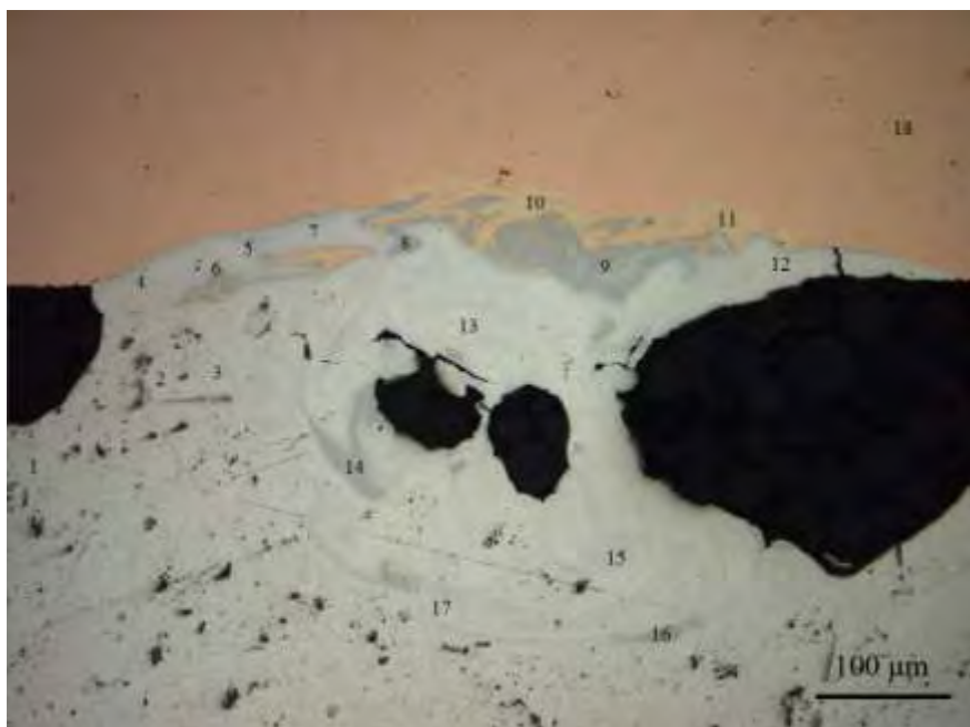
Εικ. 57: Περιοχή συγκόλλησης κατηγορίας A_{new} , Σημεία μικροσκληρομέτρησης
