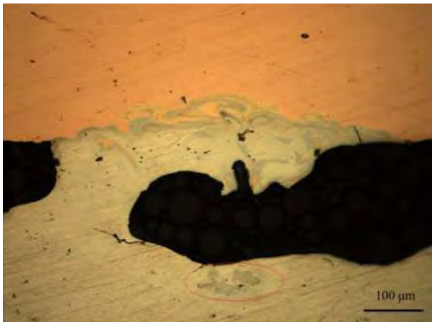
Εικ. 25: Περιοχή συγκόλλησης κατηγορίας B (200x)
