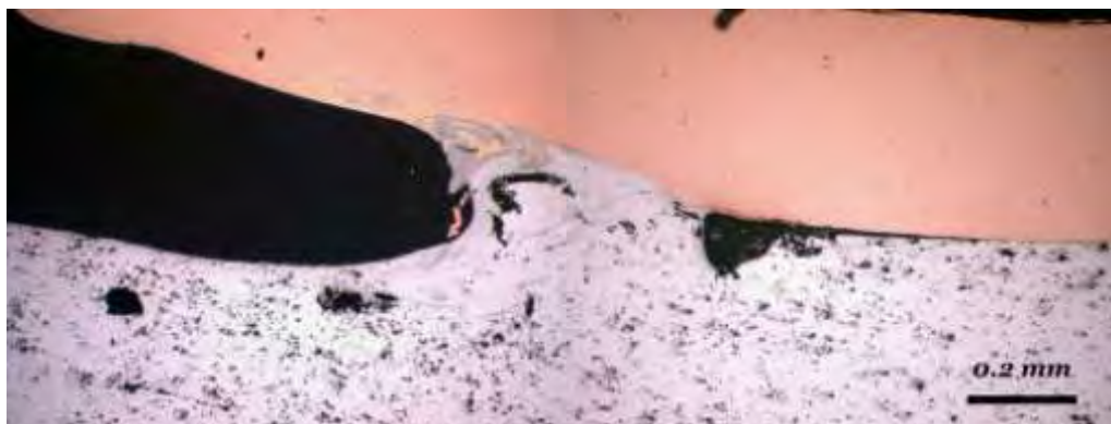
Εικ. 48: Εγκάρσια τομή περιοχής συγκόλλησης κατηγορίας ΣΤ (100x)
