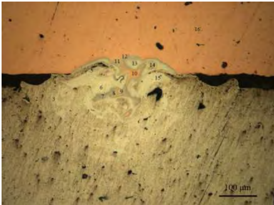
Εικ. 62: Περιοχή συγκόλλησης κατηγορίας ΣΤ, Σημεία μικροσκληρομέτρησης
