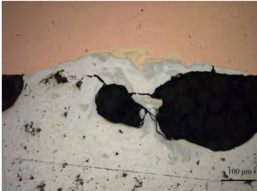
Εικ. 31: Περιοχή συγκόλλησης κατηγορίας Anew (200x)
