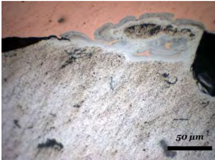
Εικ. 41: Περιοχή συγκόλλησης κατηγορίας Δ (500x)
