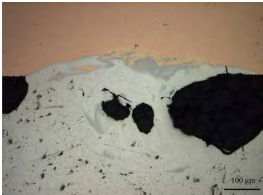
Εικ. 32: Περιοχή συγκόλλησης κατηγορίας Anew (200x)
