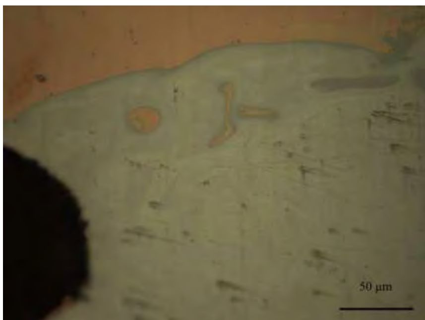
Εικ. 22: Περιοχή συγκόλλησης κατηγορίας B (500x)
