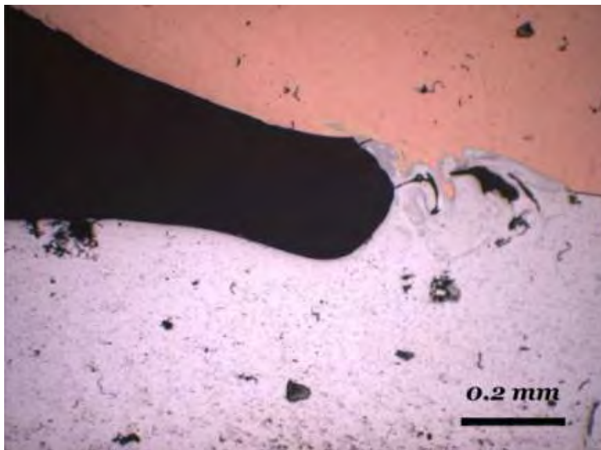
Εικ. 45: Εγκάρσια τομή περιοχής συγκόλλησης κατηγορίας E (100x)
