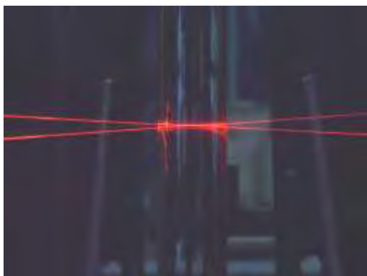
Σχήμα 5-4: Ο όγκος ελέγχου για μεσαίες συγκεντρώσεις σωματιδίων
