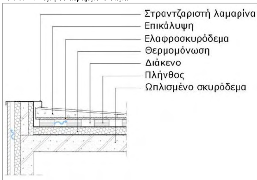
Εικ. 6.11: Τομή σε αεριζόμενο δώμα
