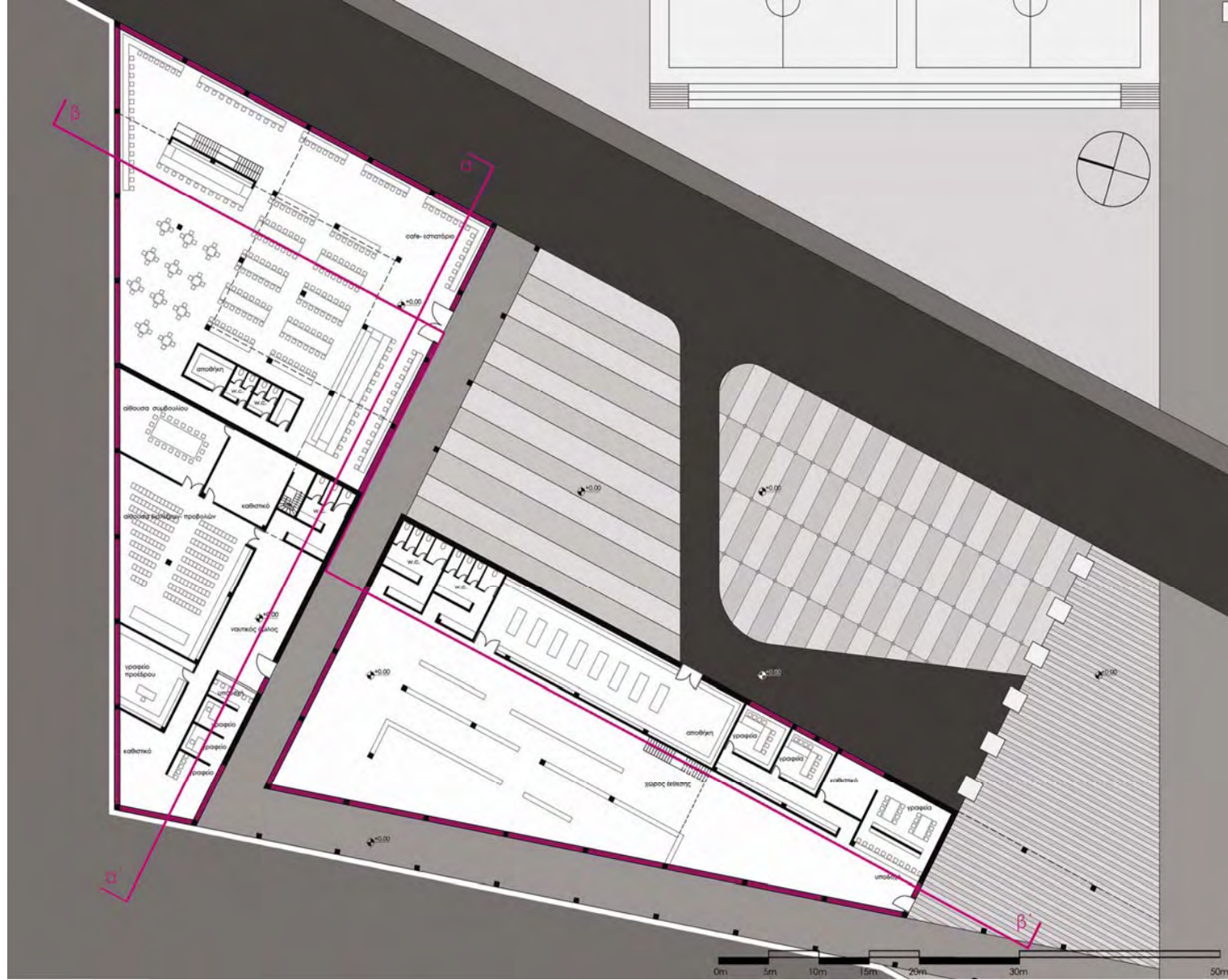
Εικόνα 60. Κάτοψη συγκροτήματος ναυτικού ομίλου_στάθμη +2.00m.
