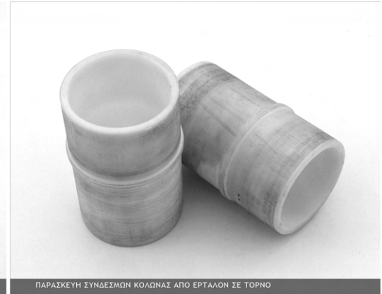
ΠΑΡΑΣΚΕΥΗ ΣΥΝΔΕΣΜΩΝ ΚΟΛΩΝΑΣ ΑΠΟ ΕΡΤΑΛΟΝ ΣΕ ΤΟΡΝΟ
