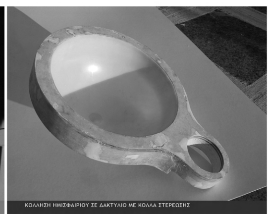
ΚΟΛΛΗΣΗ ΗΜΙΣΦΑΙΡΙΟΥ ΣΕ ΔΑΚΤΥΛΙΟ ΜΕ ΚΟΛΛΑ ΣΤΕΡΕΩΣΗΣ
