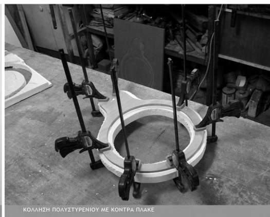
ΚΟΛΛΗΣΗ ΠΟΛΥΣΤΥΡΕΝΙΟΥ ΜΕ ΚΟΝΤΡΑ ΠΛΑΚΕ
