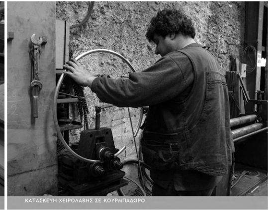
ΚΑΤΑΣΚΕΥΗ ΧΕΙΡΟΛΑΒΗΣ ΣΕ ΚΟΥΡΜΠΑΔΟΡΟ
