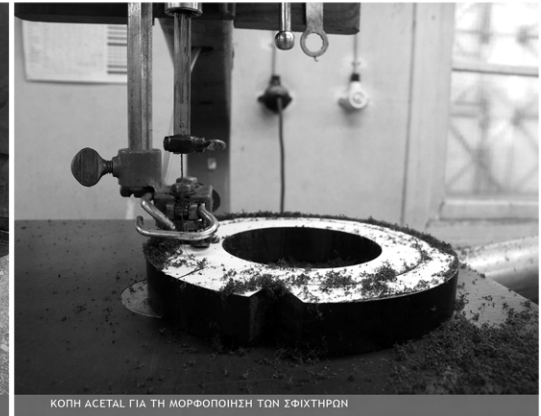
ΚΟΠΗ ΑΣΕΤΑΛ ΓΙΑ ΤΗ ΜΟΡΦΟΠΟΙΗΣΗ ΤΩΝ ΣΦΙΧΤΗΡΩΝ
