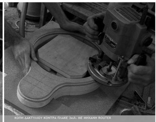
ΚΟΠΗ ΔΑΚΤΥΛΙΟΥ ΚΟΝΤΡΑ ΠΛΑΚΕ 3x1λ. ΜΕ ΜΗΧΑΝΗ ROUTER
