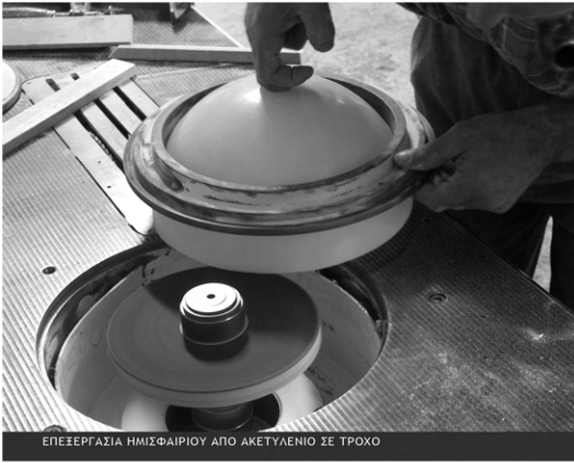
ΕΠΕΞΕΡΓΑΣΙΑ ΗΜΙΣΦΑΙΡΙΟΥ ΑΠΟ ΑΚΕΤΥΛΕΝΙΟ ΣΕ ΤΡΟΧΟ
