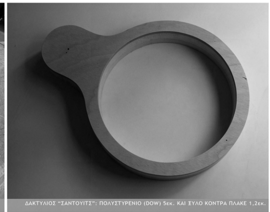
ΔΑΚΤΥΛΙΟΣ "ΣΑΝΤΟΥΙΤΣ": ΠΟΛΥΣΤΥΡΕΝΙΟ (DOW) 5εκ. ΚΑΙ ΞΥΛΟ ΚΟΝΤΡΑ ΠΛΑΚΕ 1,2εκ.
