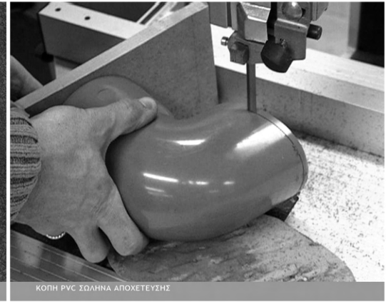
ΚΟΠΗ PVC ΣΩΛΗΝΑ ΑΠΟΧΕΤΕΥΣΗΣ
