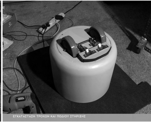
ΕΓΚΑΤΑΣΤΑΣΗ ΤΡΟΧΩΝ ΚΑΙ ΠΟΔΙΟΥ ΣΤΗΡΙΞΗΣ
