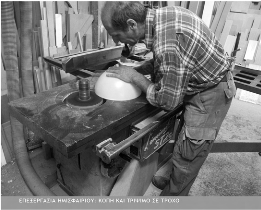
ΕΠΕΞΕΡΓΑΣΙΑ ΗΜΙΣΦΑΙΡΙΟΥ: ΚΟΠΗ ΚΑΙ ΤΡΙΨΙΜΟ ΣΕ ΤΡΟΧΟ
