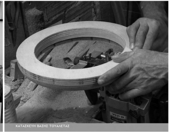
ΚΑΤΑΣΚΕΥΗ ΒΑΣΗΣ ΤΟΥΑΛΕΤΑΣ
