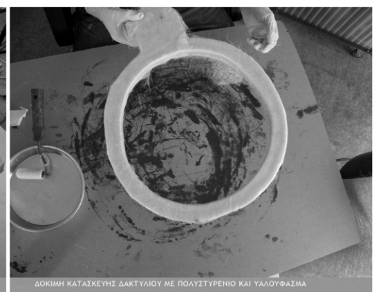
ΔΟΚΙΜΗ ΚΑΤΑΣΚΕΥΗΣ ΔΑΚΤΥΛΙΟΥ ΜΕ ΠΟΛΥΣΤΥΡΕΝΙΟ ΚΑΙ ΥΑΛΟΥΦΑΣΜΑ
