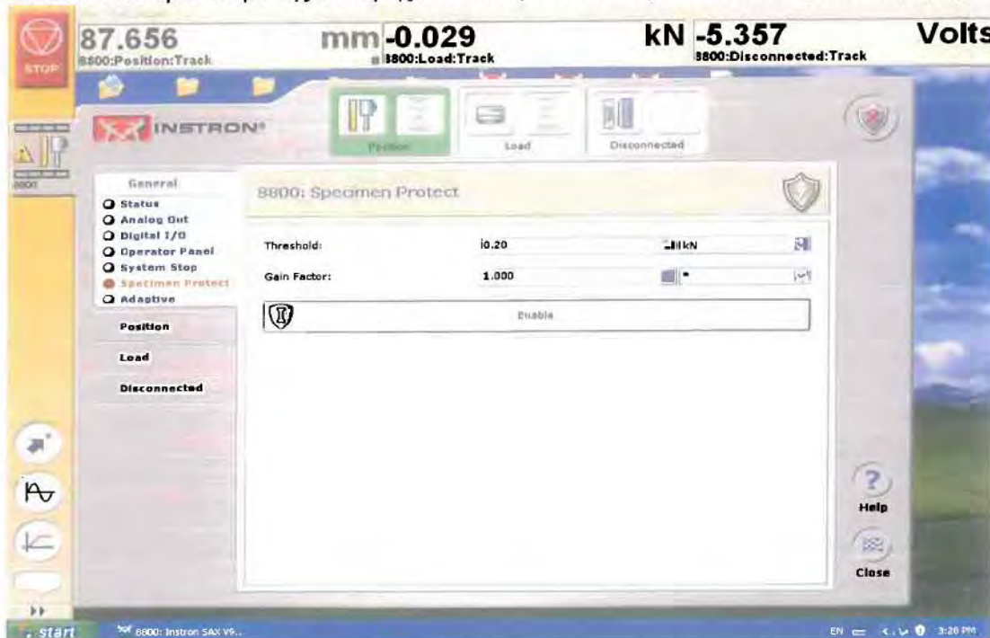
Εικ. 3-12: Επιλογή τάσης ασφαλείας για την προστασία του δοκιμίου κατά την τοποθέτησή του στο σύστημα
