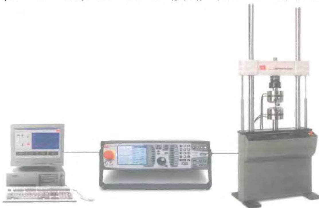
Εικ. 3-1: Σύστημα ελέγχου μηχανικών δοκιμών κλειστού βρόχου (Η/Υ-κονσόλας-πλαισίου φόρτισης)
