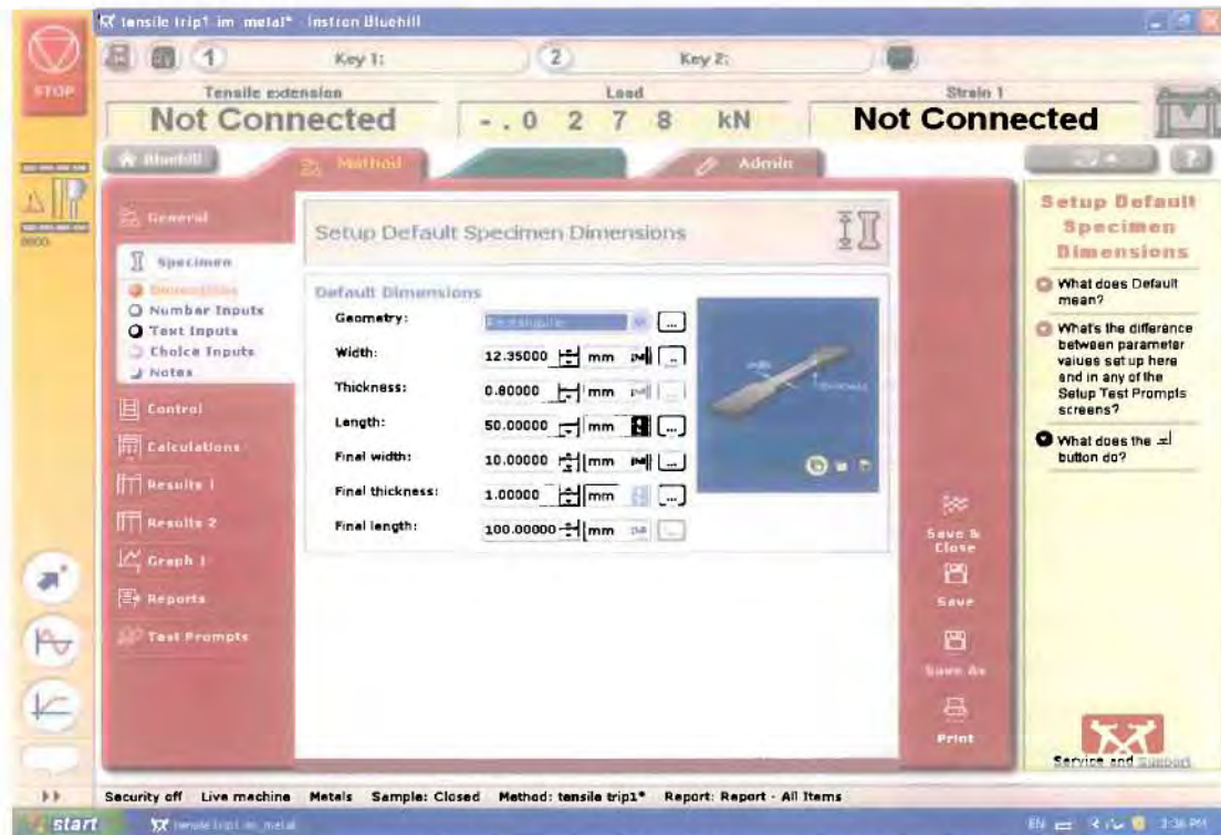
Εικ. 3-15: Ορισμός της γεωμετρίας και των διαστάσεων του δοκιμίου στον εφελκυσμό
