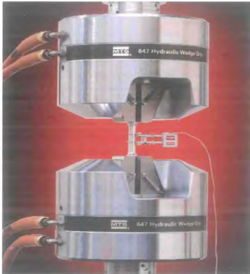
Εικ. 3-6: Δοκιμή με τοποθέτηση επιμηκυνσιόμετρου
