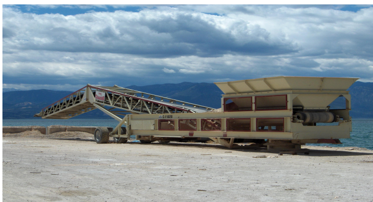
Εικόνα 23. Ταινία-μεταφορέας για αδρανή υλικά
