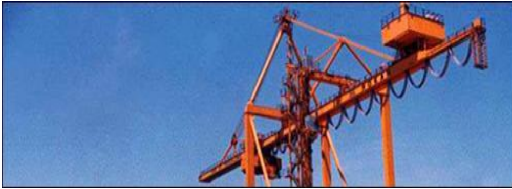
Εικόνα 9. Γερανογέφυρα Post Panamax
