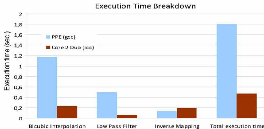
Σχήμα 4.2: Ο χρόνος εκτέλεσης της εφαρμογής στο PPE (με χρήση του gcc ) και στον Core2 Duo (με χρήση του icc ).
