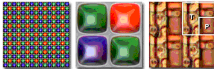
Σχήμα 3.7: (α) Φίλτρο Bayer, (β) Mosaic Array, (γ) Φωτοδιόδοι
