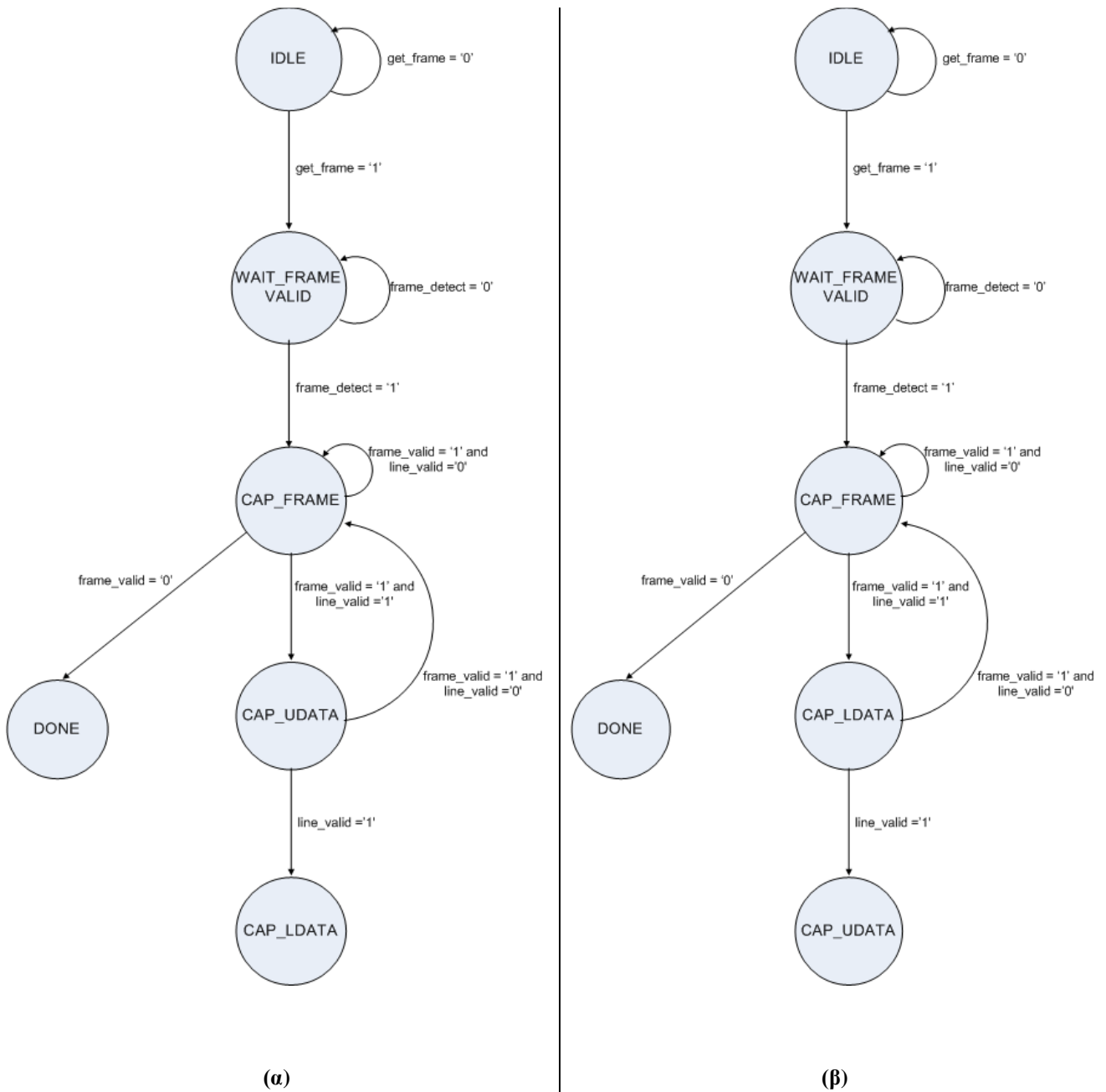
Σχήμα 6.6: Μηχανή πεπερασμένων καταστάσεων καταγραφής εικόνας
