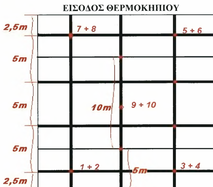
Σχήμα 3.5. Απεικόνιση των σημείων τοποθέτησης των 10 αισθητήρων στα 2,5μέτρα καθώς και στο 0,5 μέτρο από την επιφάνεια του εδάφους
