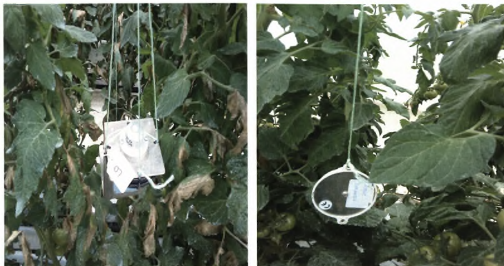
Εικόνα 3.9. Αισθητήρες τοποθετημένοι στο 0,5 μέτρο από την επιφάνεια του εδάφους
