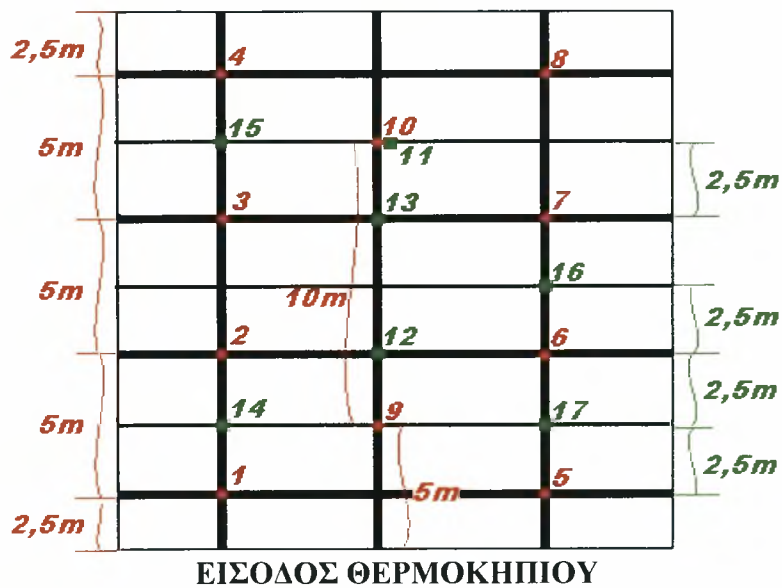
Σχήμα 3.4. Απεικόνιση των σημείων τοποθέτησης 7 επιπλέον αισθητήρων σε σημεία ενδιάμεσα στα φυτά της καλλιέργειας
