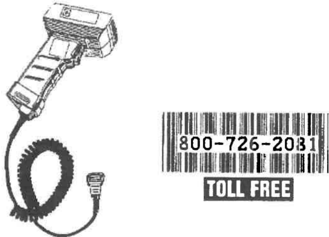
Σχήμα 5.1: Γραμμικός κώδικας και αναγνώστης γραμμικού κώδικα.
