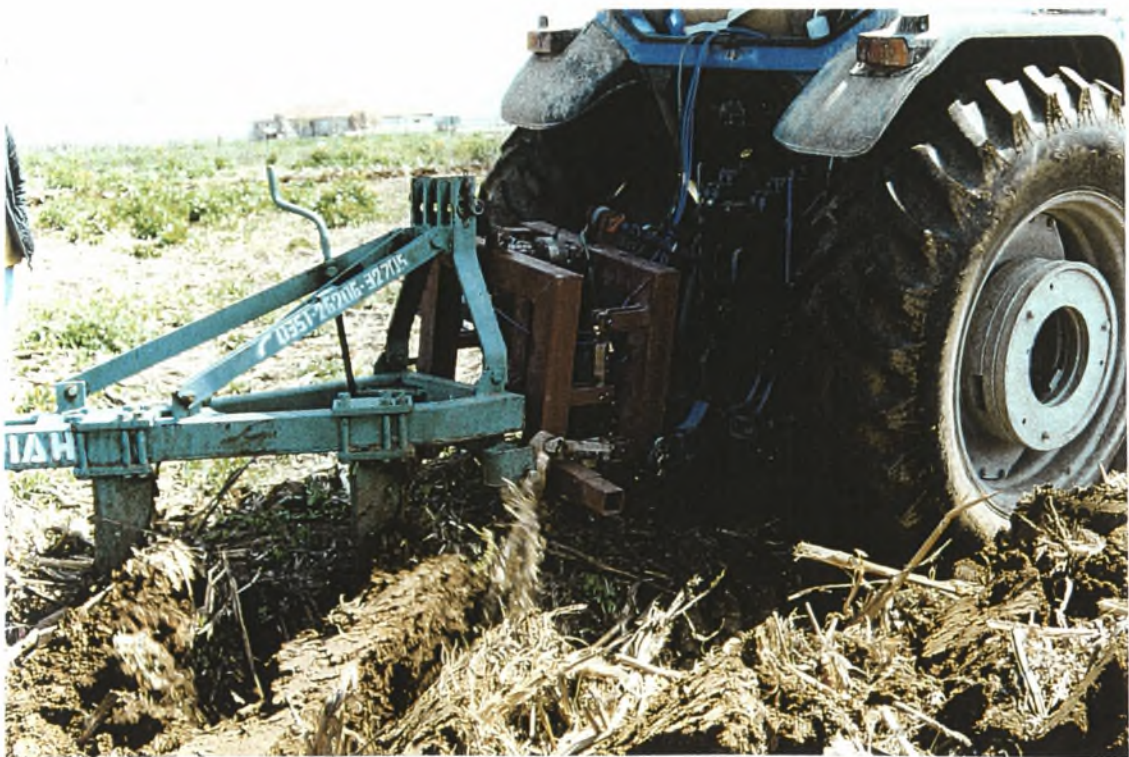
Άρωση με τετράουνο άροτρο. Παρεμβολή του συστήματος μέτρησης δυνάμεων μεταξύ γεωργικού ελκυστήρα και παρελκομένου.
