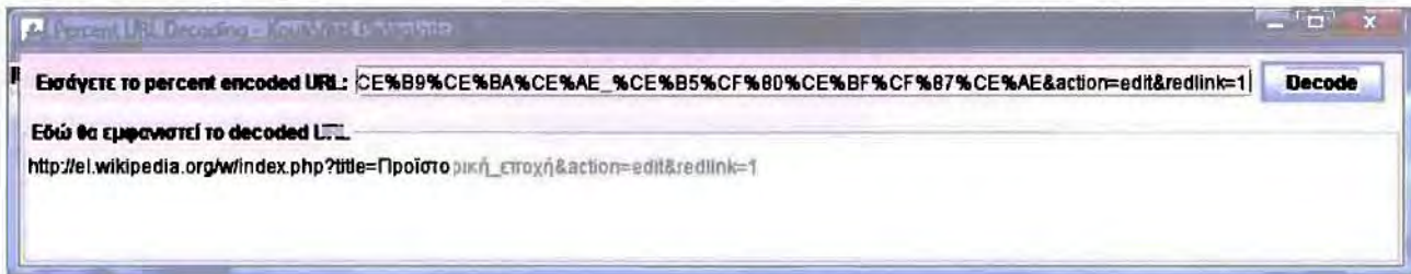
Εικόνα 7.14 Φόρμα που ο χρήστης τοποθετεί το Percent Encoded URL και πατώντας το κουμπί Decode του εμφανίζεται το decoded URL
