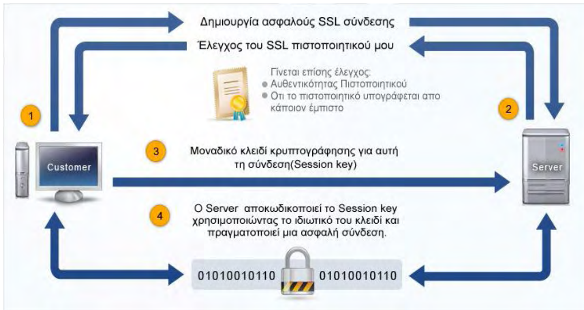
Εικόνα 13: Τρόπος λειτουργίας Πρωτοκόλλου SSL http://www.tophost.gr/files/images/HOW-SSL-WORKS.jpg
