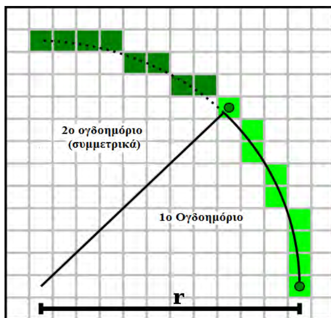
Εικόνα 29. Δημιουργία του κύκλου χρησιμοποιώντας το πρώτο ογδοημόριο και δημιουργώντας τα υπόλοιπα συμμετρικά ως προς αυτό.
