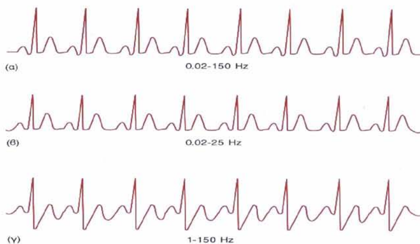
Εικόνα 8.1 Παραμόρφωση συχνότητας του ΗΚΓ. (α) πραγματικό ΗΚΓ, (β) το ίδιο ΗΚΓ όταν περάσει από κύκλωμα χαμηλού κέρδους στις υψηλές συχνότητες, (γ) το ίδιο ΗΚΓ όταν περάσει από κύκλωμα χαμηλού κέρδους στις χαμηλές συχνότητες.[4]
