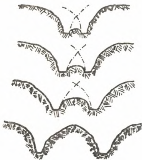
Σχήμα 9: Αναμόχλευση του εδάφους από δύο υνιά που έχουν αλληλεπίδραση όταν κατεργάζονται το έδαφος στο ίδιο βάθος.
