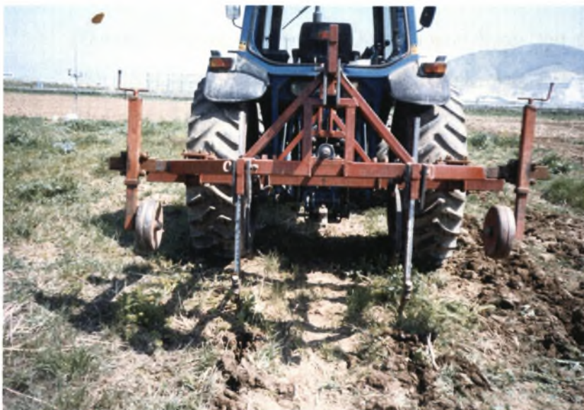
Σχήμα 13: Πλαίσιο με δύο σταθερά σώματα και τροχούς εδάφους αναρτημένο στο υδραυλικό σύστημα του γεωργικού ελκυστήρα.
