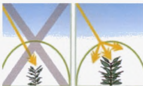
Σχήμα 3: Σχηματική παράσταση της πορείας της ακτινοβολίας, σε θερμοκήπιο με ή χωρίς υλικό κάλυψης που διαχέει την ακτινοβολία
