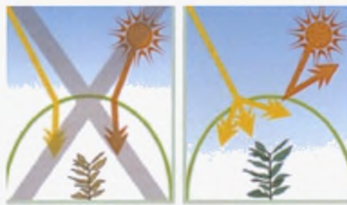
Σχήμα 7: Σχηματική παράσταση της πορείας της ακτινοβολίας, σε θερμοκήπιο με ή χωρίς υλικό κάλυψης που απορροφά την κοντινή υπέρυθη ακτινοβολία (NIR)
