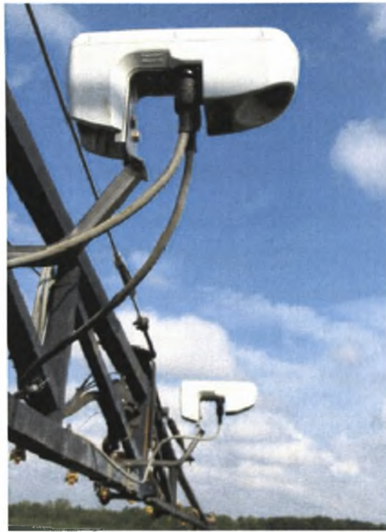
Σχήμα 2. Άποψη των ανιχνευτών GreenSeeker® RT200 τοποθετημένοι επάνω στο ψεκαστικό μηχάνημα
