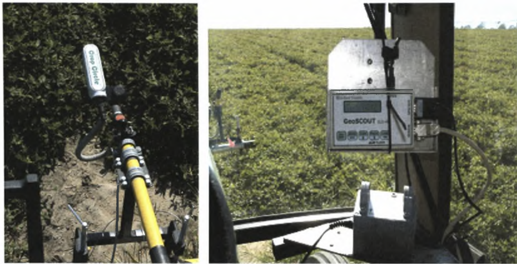
Σχήμα 9. Ο ανιχνευτής crop circle και το datalogger GeoSCOUT
