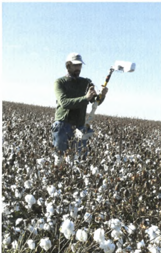
Σχήμα 3. Μετά τις 23 Αυγούστου οι μετρήσεις NDVI έγιναν με φερόμενο ανιχνευτή GreenSeeker® RT200.
