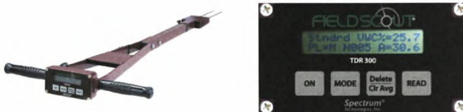
Σχήμα 12. Ο ανιχνευτής εδαφικής υγρασίας TDR 300
