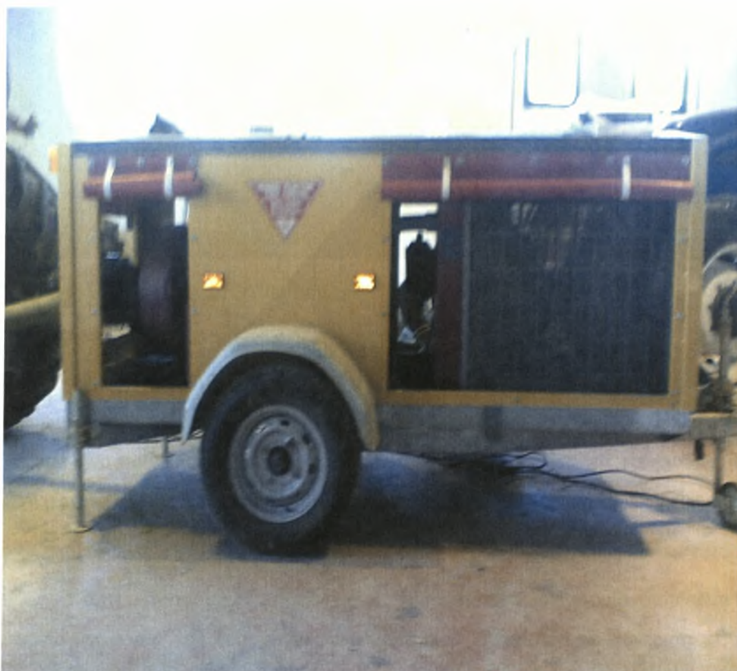
Σ χήμα 3: Το ηλεκτρικό δυναμόμετρο για δοκιμές γεωργικού ελκυστήρα στο ΡΤΟ, FROMENT XT200.
