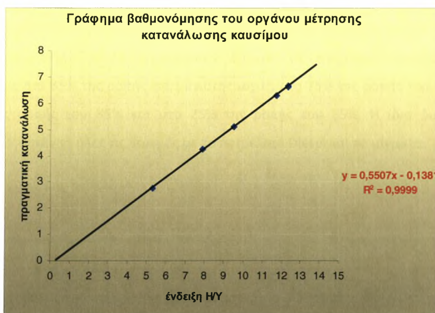
Σχήμα 5: Γράφημα βαθμονόμησης του οργάνου μέτρησης της κατανάλωσης καυσίμου.
