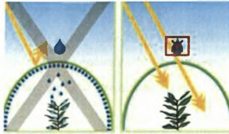
Σχημα 4. Σχηματική παράσταση αντισταγονικής προστασίας(Plastika kritis S.A.) Αντιομιχλικές (Anti-mist)
