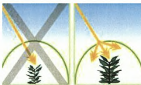
Σχήμα 3. Σχηματική παράσταση διάχυσης του φωτός (Plastika kritis S.A.)
