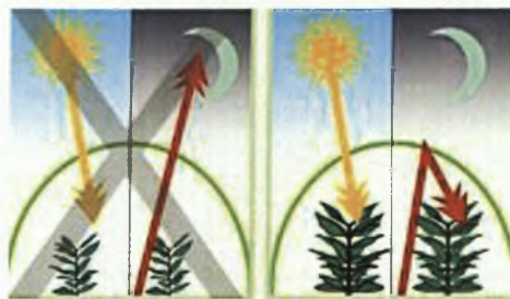
Σχήμα 6. Σχηματική απεικόνιση τρόπου λειτουργίας θερμικού φιλμ. (Plastika kritis S.A.)
