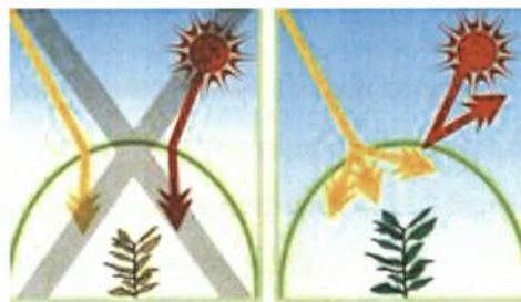
Σχήμα 5 . Σχηματική παράσταση τρόπου ψύξης (Plastika kritis S.A.)
