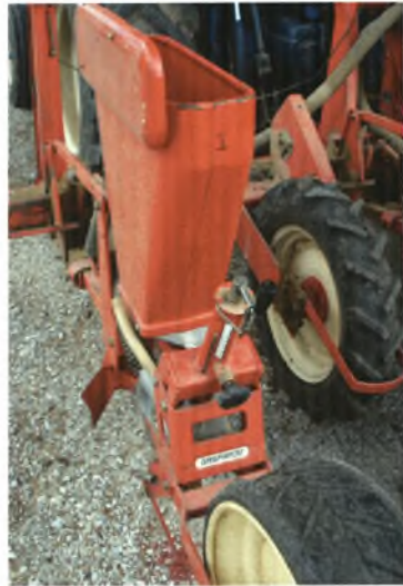
Εικόνες 4.4.3 και 4.4.4. Η πνευματική σπартική μηχανή που χρησιμοποιήθηκε για τη σπορά.
