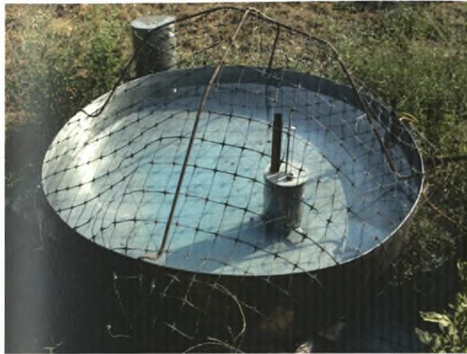
Εικόνα 4.6.1.1. Εξατμισόμετρο τύπου Α.
