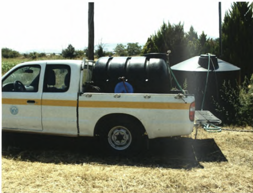
Εικόνες 4.5.9 και 4.5.10. Τοποθέτηση λύματος σε δεξαμενή PVC.
