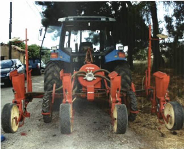
Εικόνες 4.4.3 και 4.4.4. Η πνευματική σπартική μηχανή που χρησιμοποιήθηκε για τη σπορά.
