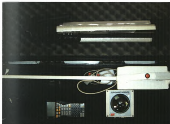
Εικόνα 4.6.2.1. Συσκευή μέτρησης L.A.I..
