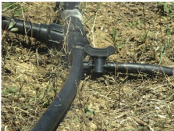
Εικόνες 4.5.2 και 4.5.3. Σύνδεση αγωγών μεταφοράς με αγωγούς εφαρμογής.
