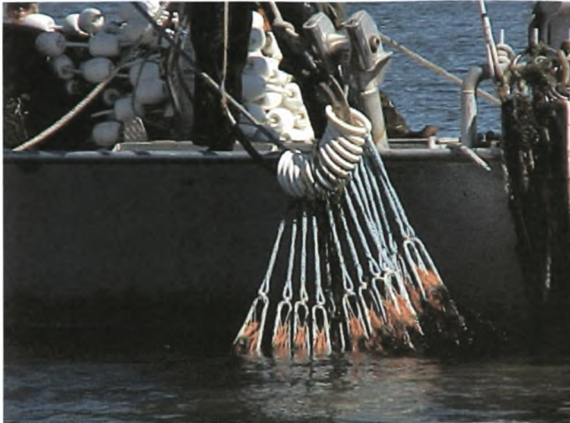
Εικόνα 5. Συλλογή συρματόσχοινου έτσι ώστε να επιτευχθεί η δημιουργία του σάκου ( http://www.dfg.ca.gov/northernpike/images/photoq.jpg ).
