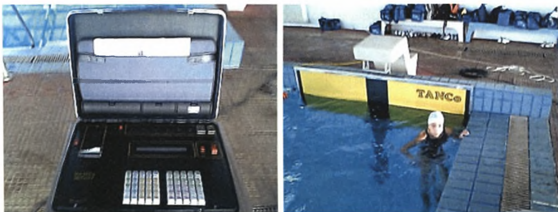
Εικόνα 1: Ηλεκτρονικό σύστημα χρονομέτρησης (TanCo sports timing). Η τερματική συσκευή μεταφοράς και καταγραφής-εκτύπωσης των δεδομένων της χρονομέτρησης (Αριστερά.) Η ηλεκτρονική πλάκα η οποία περιλαμβάνεται στο κύκλωμα που ενεργοποιείται με το άγγιγμα του κολυμβητή (Δεξιά).
