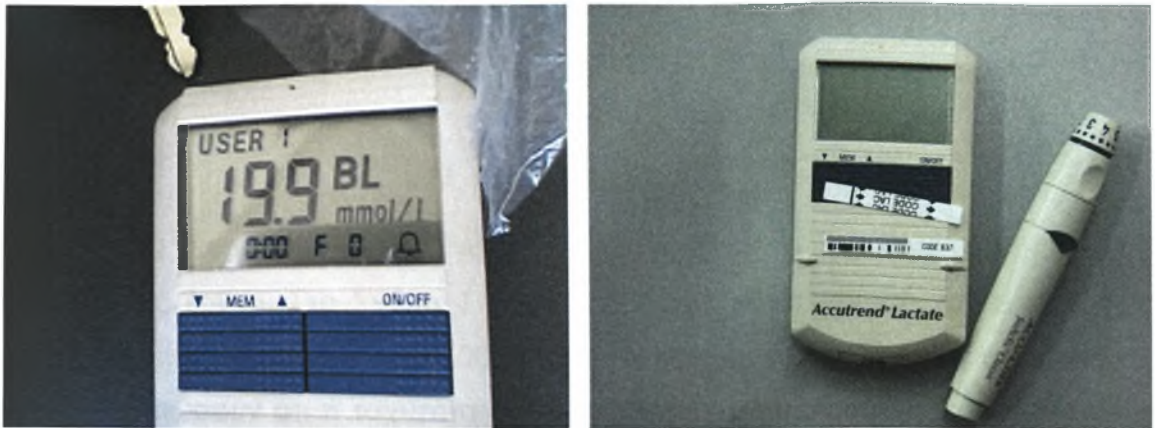
Εικόνα 5: Η συσκευή ανάλυσης των δειγμάτων αίματος για τον προσδιορισμό της συγκέντρωσης γαλακτικού (μικροφωτόμετρο Accutrend Lactate). Αριστερά φαίνεται η τιμή γαλακτικού (19.9 mmol/L) μετά από μια δοκιμασία ενώ δεξιά φαίνεται η ειδική βελόνα καθώς και οι ταινίες πάνω στις οποίες τοποθετείται το αίμα για τον προσδιορισμό του γαλακτικού.
