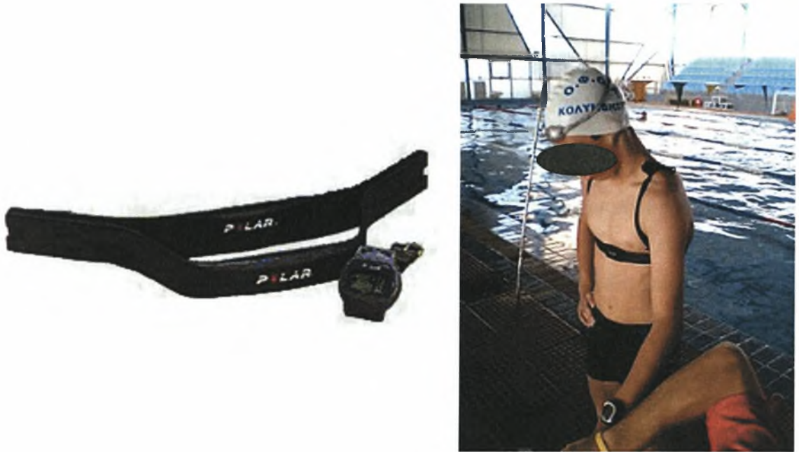
Εικόνα 2: Το τηλεμετρικό σύστημα καταγραφής της καρδιακής συχνότητας και ο τρόπος εφαρμογής του στους κολυμβητές (Polar S610i, Polar Electro, Kampele, Finland)
